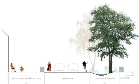
Sektionsskiss för Insatsvägen, befintlig bebyggelse samt dagvattendike.
