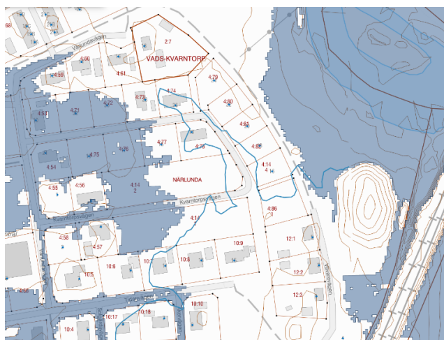
Figur 18: Beräknat högsta flöde för Tidan, MSB 2024. Höjddkurvan för +72,5 meter över nollplanet blåmarkerad.
