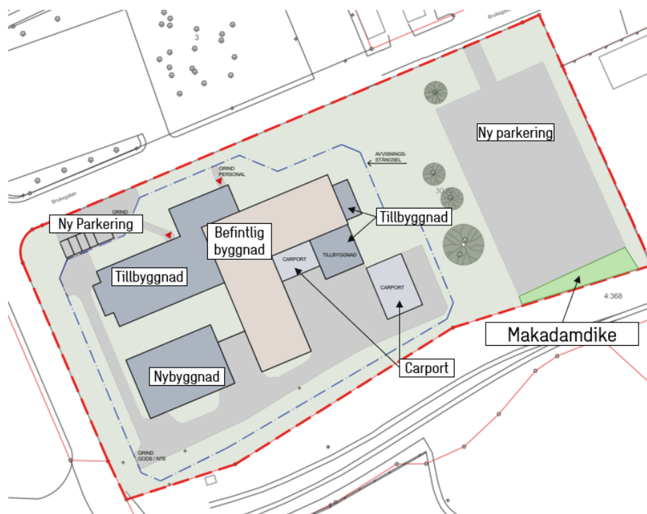
Förslag på situationsplan. Ljusgråa ytor är nya asfalterade ytor och det mörkgråa ytor är byggnader, läs mer under rubriken Dagvatten .
