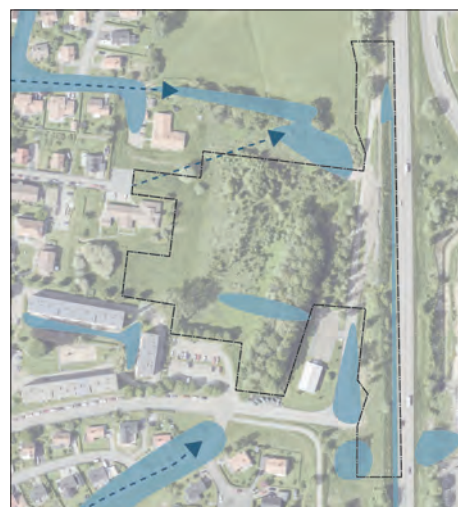
Schematisk bild över ytvattnets flödesriktning, samt lågpunkter där vattnet kan ansamlas i dagsläget
