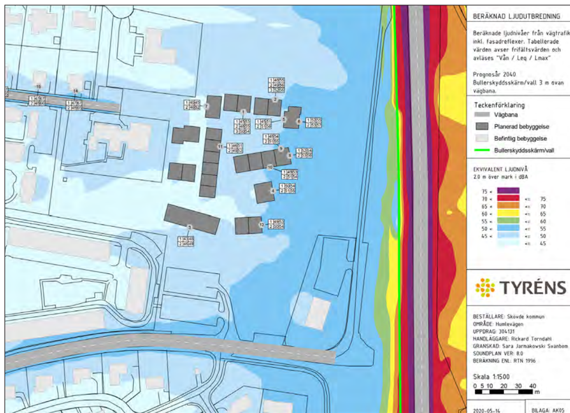
Beräknade ljudnivåer år 2040, med en 3 meter hög bullervall utmed Östra leden
