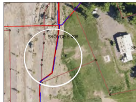
VA - ledningar som måste dras om.
