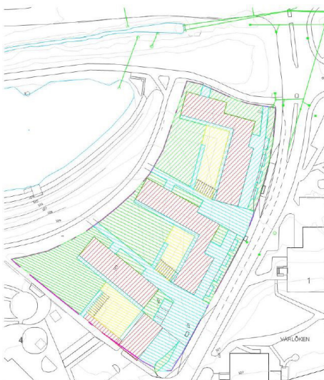
Utredningens bedömning kring omfattningen av hårdgjorda ytor (röd/gul/cyan) och grönytor inom planområdet. Befintliga anslutningspunkter till dagvattnet (grönt) finns norr om kvarteren.
