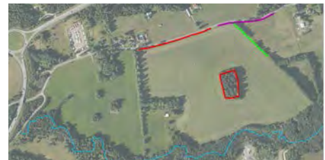
Stenmurar som bedöms omfattas av biotopskydd. De rödmarkerade föreslås bevaras. Den gröna föreslås rivas och återuppbyggas längs Ga Törebodavägen (lila).
