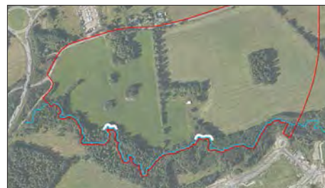
Åkrökar som behöver förses med erosionsskydd.
