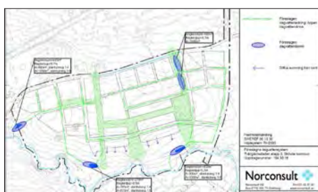
Dagvattensystem med förslag till dammstorlekar och flöden mm. För större bild se utredningens bilaga 2.
